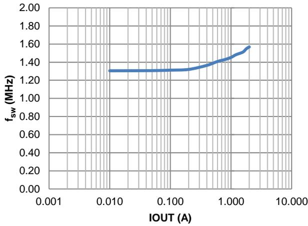
Figure 27. f<sub>sw</sub> vs. Load
