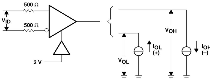
Figure 1.  $V_{OH}$ ,  $V_{OL}$
