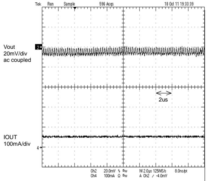
Figure 26. PWM mode Operation
