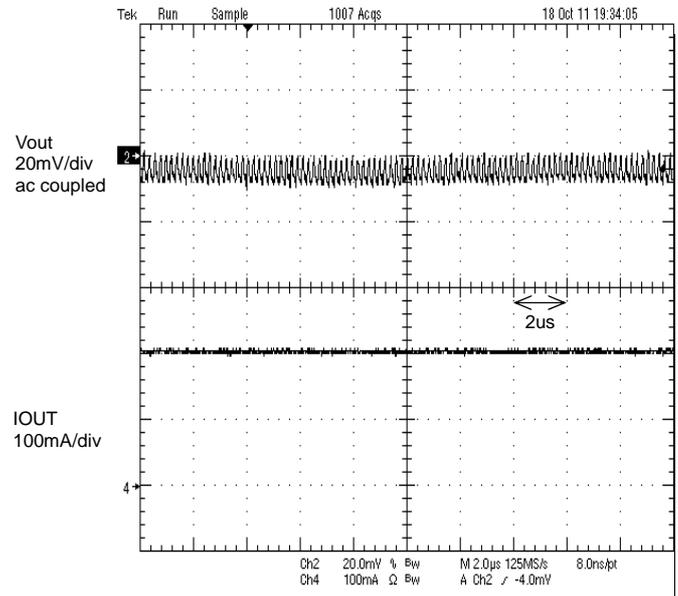
Figure 30. PWM mode Operation
