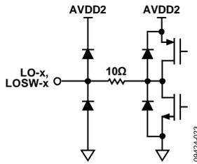
Figure 23. Equivalent LNA Output Circuit
