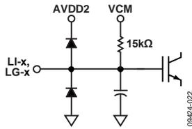
Figure 22. Equivalent LNA Input Circuit (VCM = Common-Mode Voltage)
