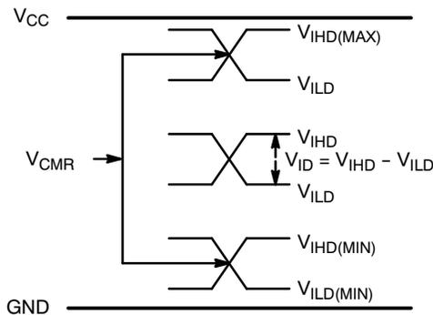
Figure 8.  $V_{CMR}$  Diagram
