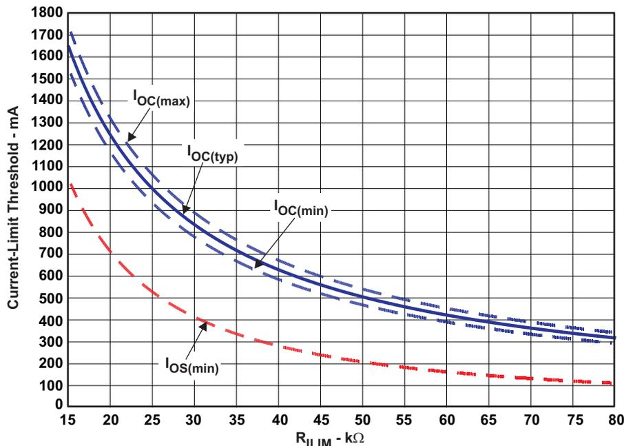
Figure 21. Current-Limit Threshold vs R<sub>ILIM</sub>
