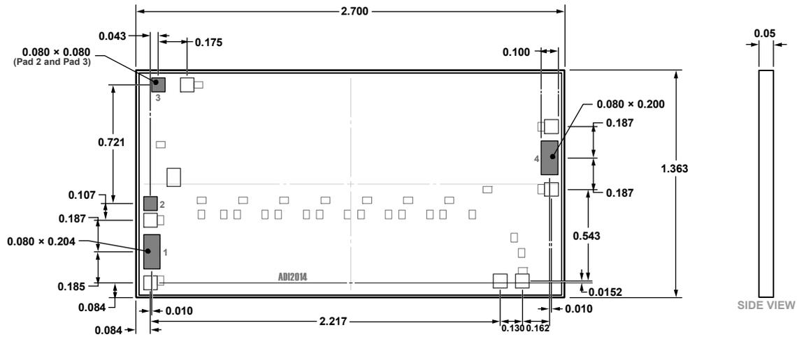
Figure 41. 4-Pad Bare Die [CHIP]
