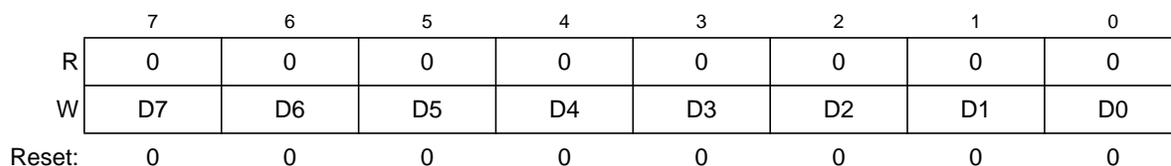
Figure 4-9. Linear Address Pointer Add Byte Register (LAPAB)
