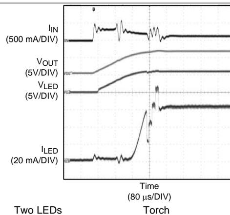
**Figure 30. Diode Detect**
