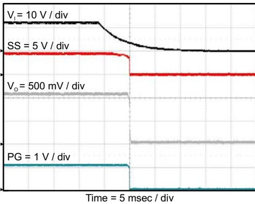
Figure 28. TPS562219 Shut Down Relative To  $V_I$
