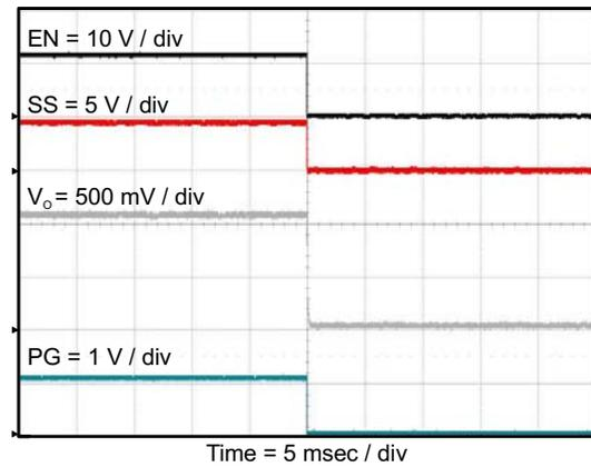
Figure 29. TPS562219 Shut Down Relative To EN
