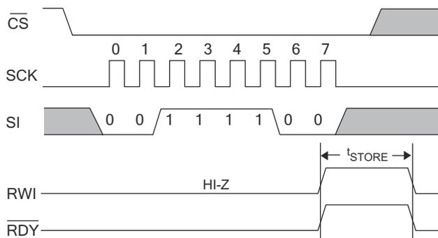
Figure 25. Software RECALL Cycle<sup>[19]</sup>
