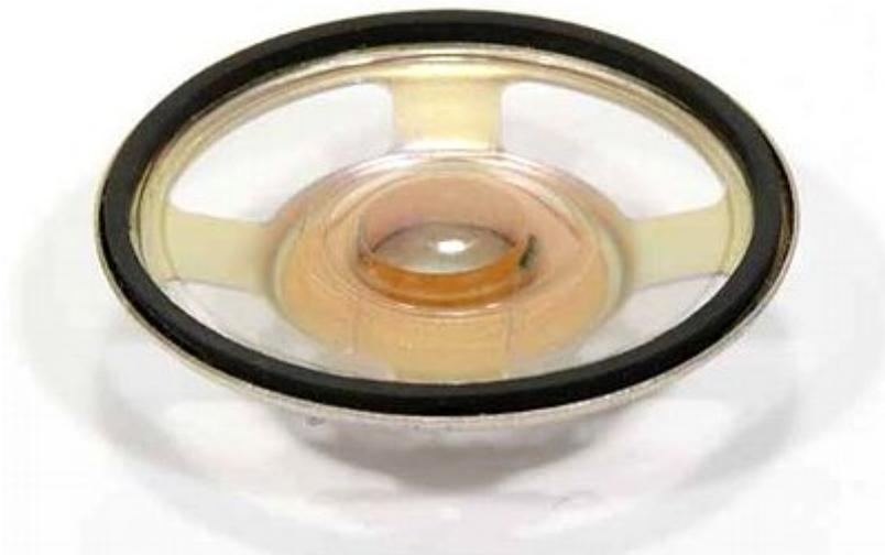
**5,7 cm (2,2") Kleinlautsprecher** mit wasserfester, transparenter Mylar Membran und Neodymmagnet. Sehr leicht. Geringe Bauhöhe. Anwendungen im Außenbereich und unter kritischen Umgebungseinflüssen möglich. Geeignet als Kontrolllautsprecher in elektrischen Geräten. Gute Sprachverständlichkeit.
