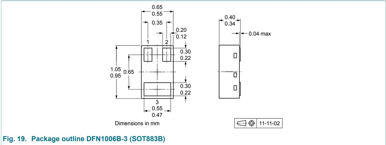
Fig. 19. Package outline DFN1006B-3 (SOT883B)
