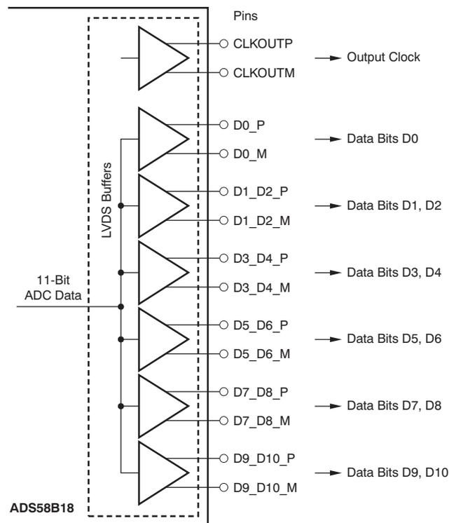
Figure 67. ADS58B18 LVDS Outputs
