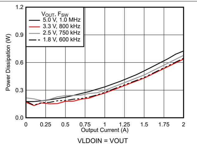
**Figure 7-8. Power Dissipation**
