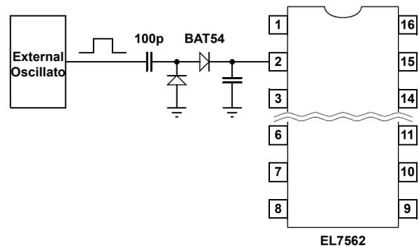
FIGURE 1. OSCILLATOR SYNCHRONIZATION
