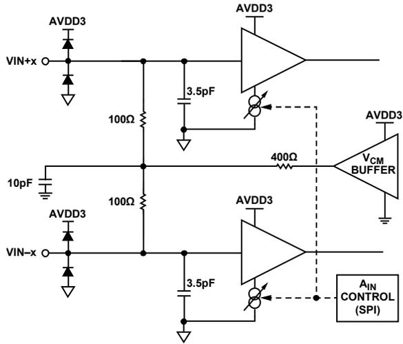
Figure 32. Analog Inputs
