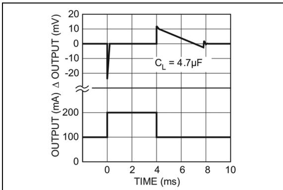
**FIGURE 2-14:** Load Transient.
