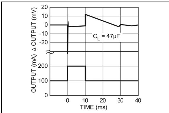
**FIGURE 2-15:** Load Transient.
