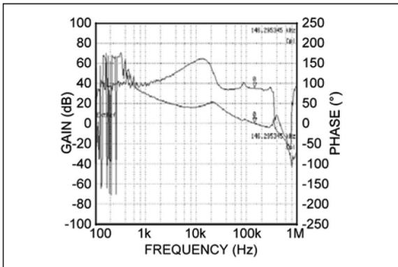
**FIGURE 2-15:** Bode Plot ( $V_{IN} = 3.6V$ ,  $V_{OUT} = 1.8V$ ).
